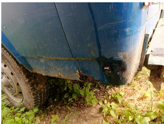
Lewy bok: skorodowane nadkole tył – ubytki blacharskie, skorodowany błotnik tył – ubytki blacharskie, dziury
