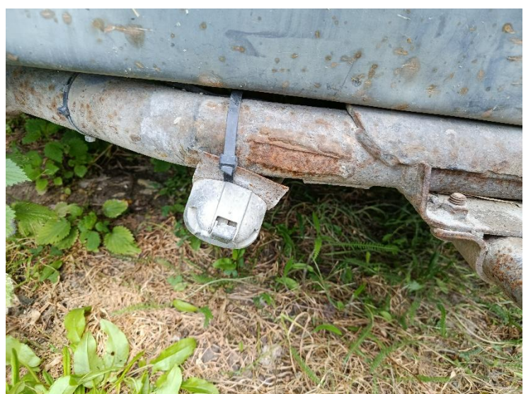
Tył: brak narożnika zderzaka strona lewa, urwane gniazdo przyłączeniowe przyczepy.
