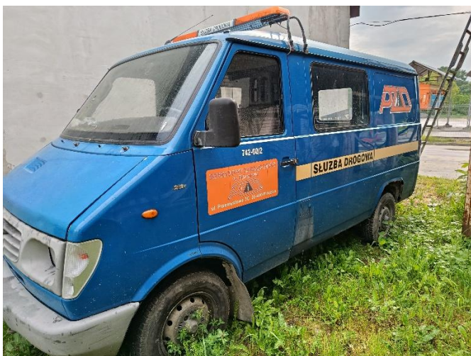
Lewy bok: skorodowane nadkole tył – ubytki blacharskie, skorodowany błotnik tył – ubytki blacharskie, dziury
