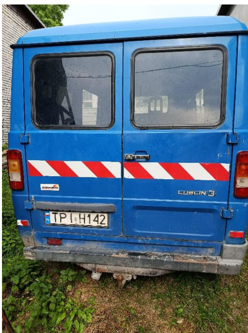
Tył: brak narożnika zderzaka strona lewa, urwane gniazdo przyłączeniowe przyczepy.
