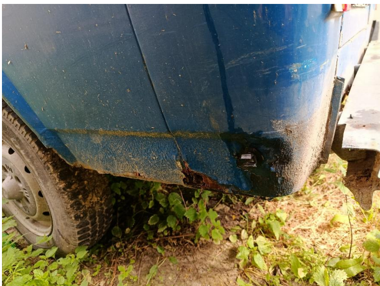
Lewy bok: skorodowane nadkole tył – ubytki blacharskie, skorodowany błotnik tył – ubytki blacharskie, dziury
